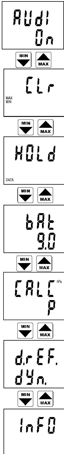
Indikuje zapnutí (On) nebo vypnutí (OFF) akustické signalizace překročení hranic alarmů. Stiskem klávesy ENTER lze aktuální stav změnit v opačný.
