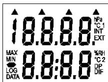
Před zapnutím přístroje je nutno připojit do konektoru externí sondu. Sonda je zkalirovaná s konkrétním přístrojem a není možné ji zaměnit za jinou (vlastníte-li více přístrojů tohoto typu). Přístroj se zapíná stiskem klávesy ON/OFF. Po zapnutí se na okamžik rozsvítí všechny znaky displeje pro jeho případnou kontrolu. Je-li klávesa ON/OFF při zapnutí přidržena stisknuta, svítí všechny znaky displeje až do uvolnění klávesy ON/OFF.
